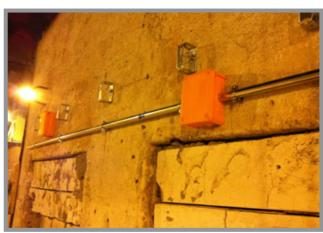
в процессе испытания в испытательной печи создают стандартный температурный режим в соответствии с разделом 6 ГОСТ 30247.0-94. Образец считают выдержавшим испытание, если сохранилась целостность электрического соединения.
