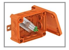
Распределительные коробки имеют предварительно смонтированную клеммную колодку из термостойкой специальной керамики. Предназначены для соединения кабелей номинальным сечением до 16 мм<sup>2</sup>.
